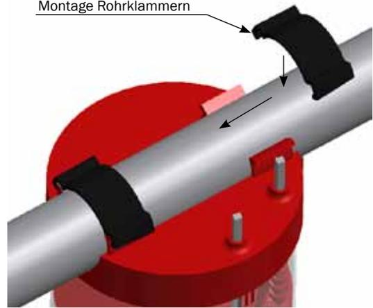
Montage mit Adapter VD2/VD6 Reduzierstück
