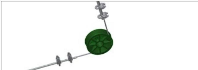
Die Spannfeder am Federdraht mit zwei Seilschlösser befestigen.
