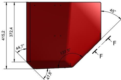
4 Markierungen für das Bohren der Löcher, die Bohrung muss beidseitig auf der Außenseite vorgenommen werden.
