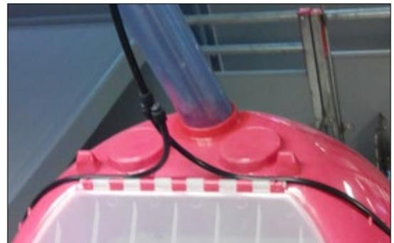
Deckel mit drei Futtereinläufen ermöglicht eine korrekte Einfüllung. Der kuppelförmiger Deckel ermöglicht die maximale Nutzung des Trichters.
