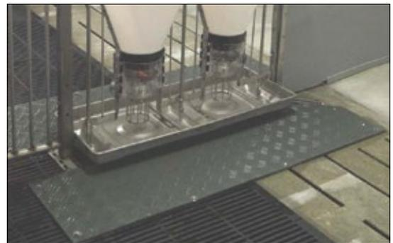
Die Kunststoffplatten unter dem Futterautomaten schützen die Betonspalten vor Säurefraß bzw. bei Gussrosten vor Korrosion. Als Einzelplatte (100x80cm) oder Doppelplatte (122 x 80cm) erhältlich.
