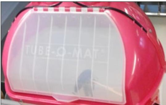
Der aufklappbare Deckel aus durchsichtigem Kunststoff ist niedrig angebracht um die manuelle Einfüllung zu erleichtern.
