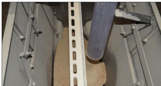
Das Futter kommt direkt aus dem Fallrohr in den Automaten.
